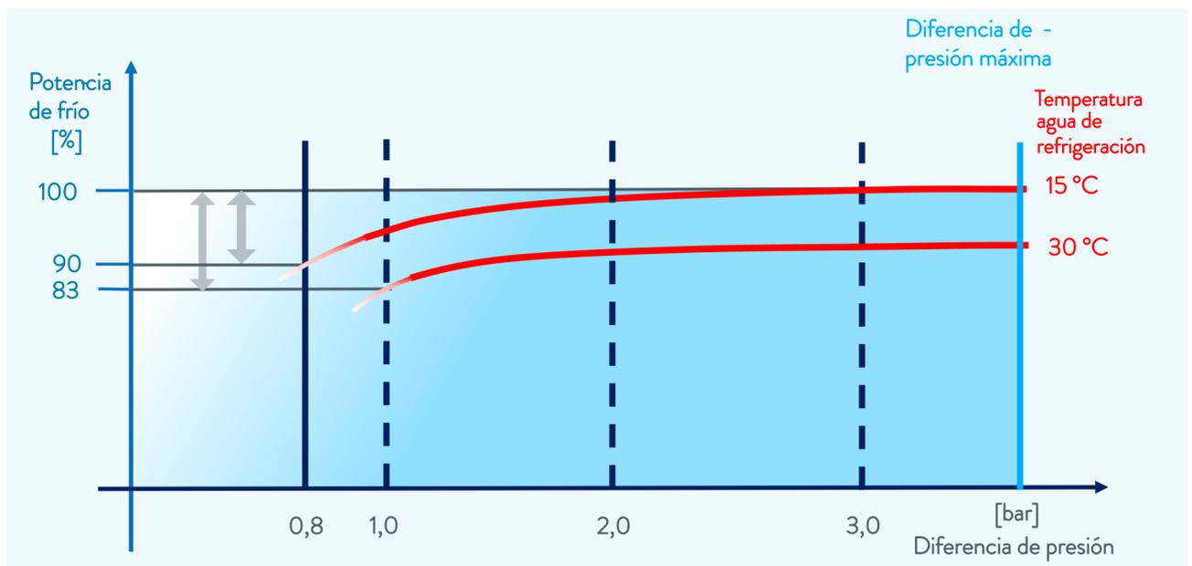
Fig. 101: Diferencia de presión del agua de refrigeración
