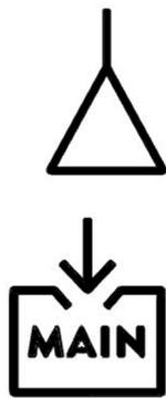
2. Conecte la manguera de aire comprimido a la tubuladura de aire comprimido del equipo de termostatación (véase el símbolo).
