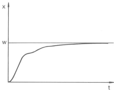
Fig. 76: Parámetros de regulación  $T_n$  y  $T_v$  demasiado altos
