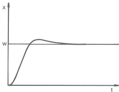
Fig. 73: Parámetro de regulación  $X_p$  demasiado alto
