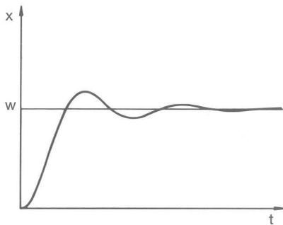
Fig. 75: Parámetros de regulación  $T_n$  y  $T_v$  demasiado bajos
