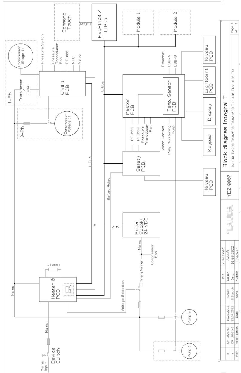
Fig. 109: Diagrama de bloques de Integral T
