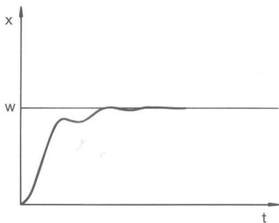
Fig. 74: Parámetro de regulación  $X_p$  demasiado bajo
